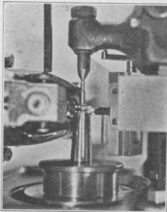
Abb. 1. Vorderansicht Gratbeseitigung mit Doppelstichel während des Fräsrauslaufs
