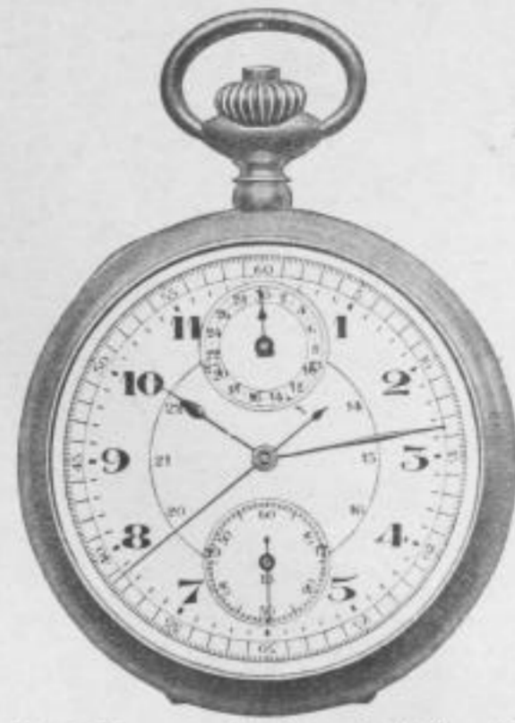
Abb. 3. Chronograph, \frac{1}{5} Sekunde, Meßbereich bis 30 Minuten, Gangdauer etwa 30 Stunden
