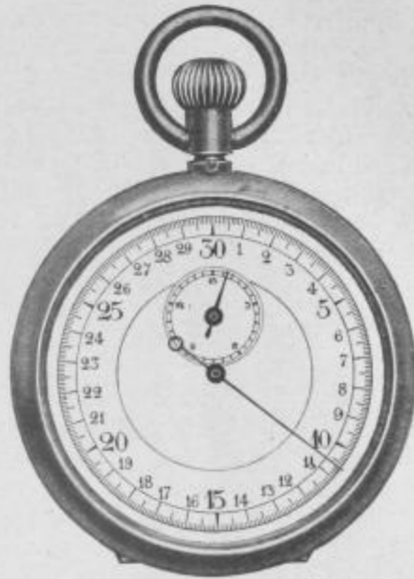
Abb. 2. Stoppuhr, \frac{1}{10} Sekunde, Meßbereich bis 15 Minuten
