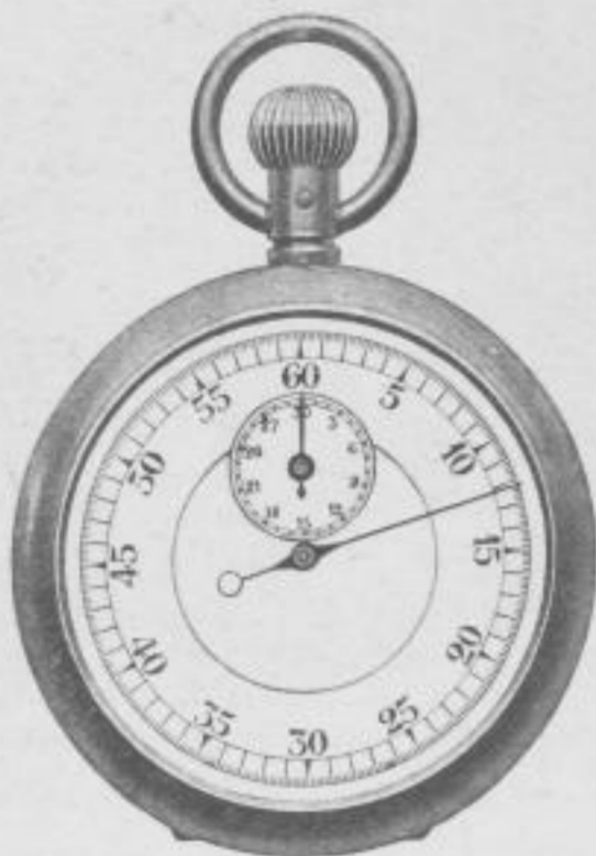
Abb. 1. Stoppuhr, \frac{1}{5} Sekunde, Meßbereich bis 30 Minuten
