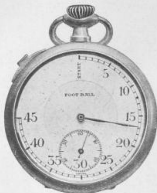
Abb. 6. Fußball-Stoppuhr bis 45 Minuten mit seitlichem Schieber für beliebiges Anhalten der Zeiger bei Spielunterbrechung und für Wiedereingangssetzen, Nullstellung durch die Krone. Mit anderen Zifferblättern für Rugby, Hockey, Polo, Boxkampf usw.
