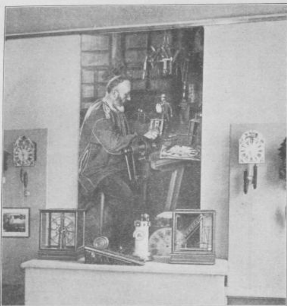
Eine reizvolle Grupplierung: Der alte Schwarzwälder Uhrmacher in seiner Werkstatt, davor zwei Modelle des sogen. „Perpetuum mobile“, eine „rollende Uhr“, die durch Ablaufen auf der schiefen Ebene aufgezogen wird, in der Mitte eine astronomische Uhr in Turmform von François Diacomann
