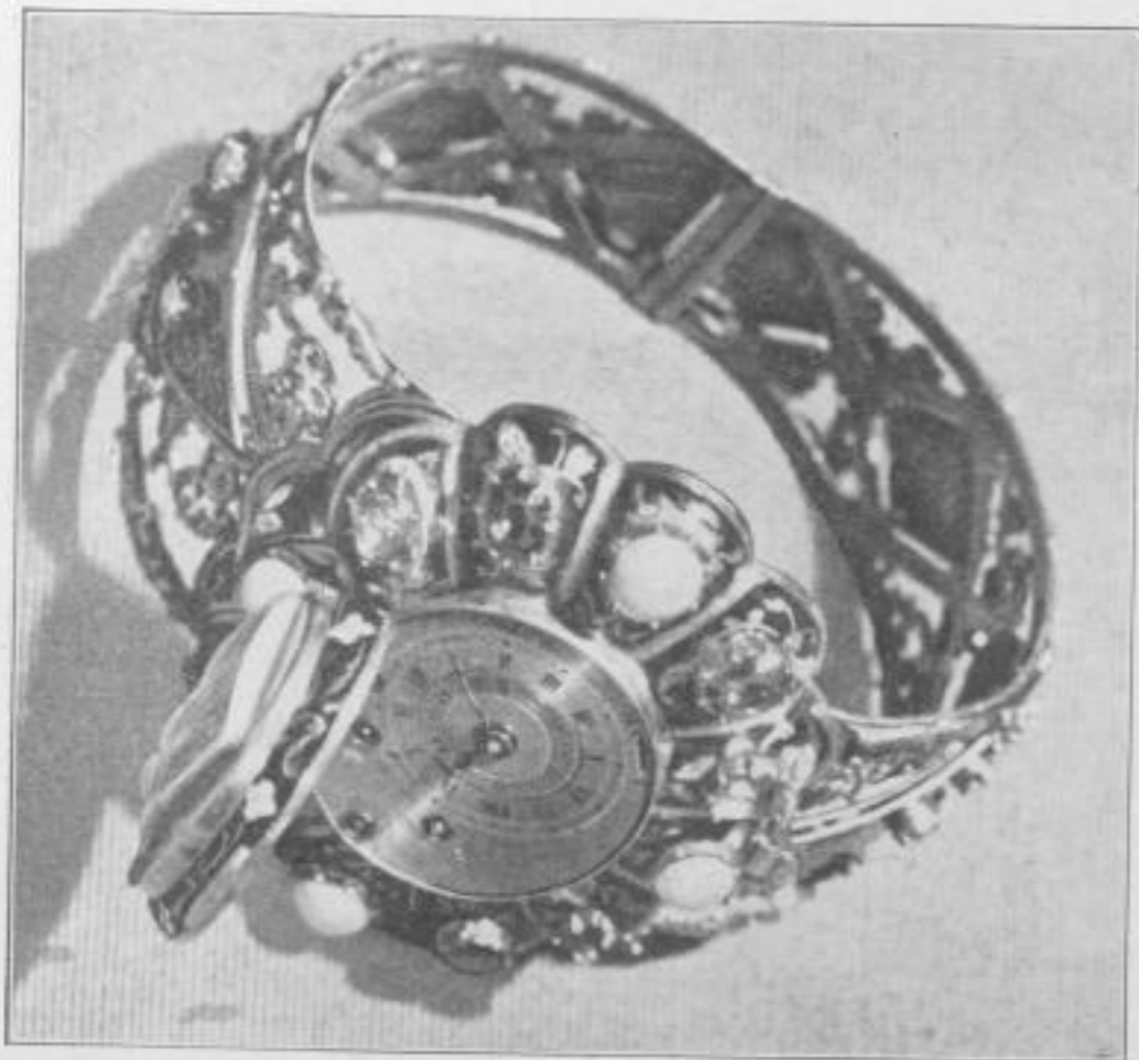
Eine Damen-Armbanduhr mit Wecker aus dem Jahre 1930. Das emaillierte Goldgehäuse ist mit Smaragden, Perlen, Goldtopasen, Rubinen und einer Gemme (diese auf dem Deckel) geschmückt. Wenn die Uhr weckt, pocht eine kleine Nadel auf den Arm der Schlafenden. Ein kleiner Zeiger auf dem goldenen Zifferblatt ermöglicht es, die Heftigkeit des Weckens der Empfindlichkeit der Haut anzupassen (Sammlung Triebold)
