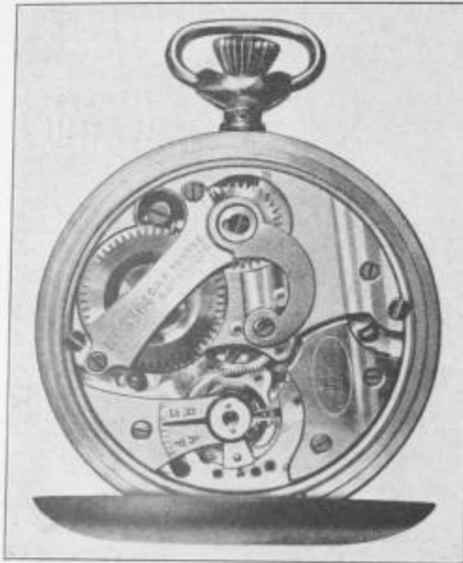
Abb. 17. Stoppuhr mit Wippenaufzug an der Werkseite
