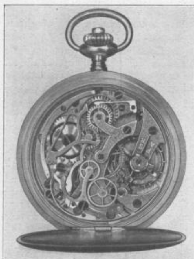
Abb. 32. Zehntelsekunden-Chronograph mit abweichender Übersetzung im Chronographenwerk
