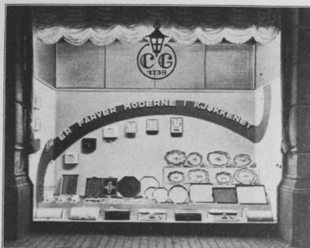
Abb. 3. Schaufenster mit Mischlichtbeleuchtung. Die Schrägstrahler sind abwechselnd mit einer Glüh- und einer Quecksilberlampe gleicher Lichtleistung bestückt
