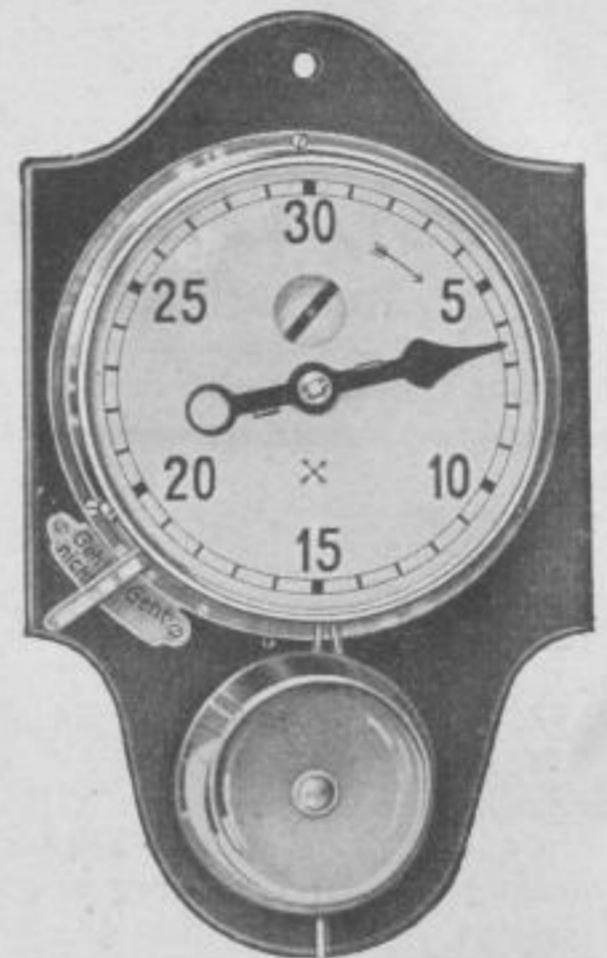
Abb. 2. Kontrolluhr mit alle 2 Minuten ertönendem kurzen Glockenzeichen und längerem Zeichen nach Ablauf der Einstellzeit
