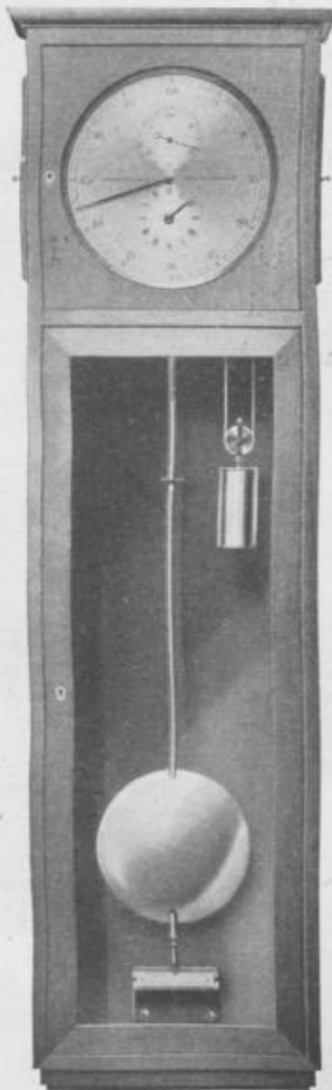
Sekunden-Pendeluhr mit Nickelstahl-Pendel
