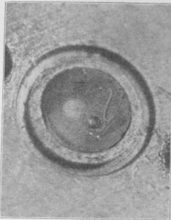
Abb. 5. Vollkommen verhartetes Öl mit Laufspur auf dem Deckstein
