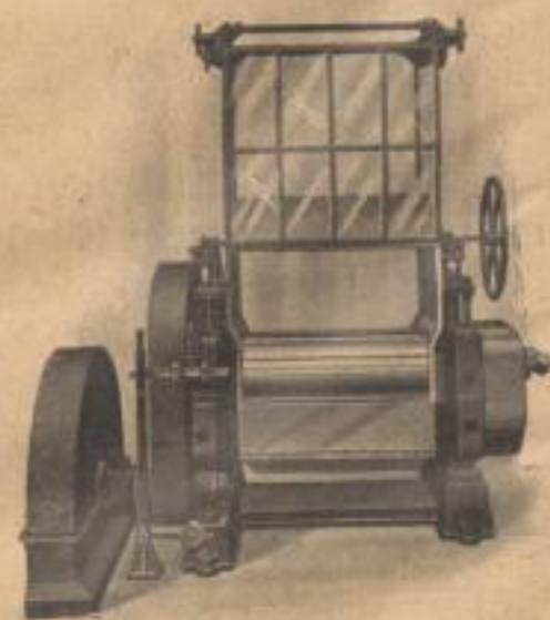
Abb. 4. Mischwalzwerk. (G. Siempelkamp & Co.)
