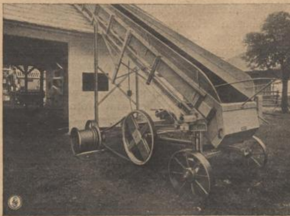
Bild 3: Rollmotor treibt Höhenförderer an
