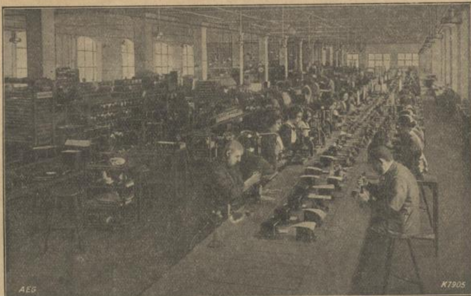
Abb. 7. Zusammenbau der Zähler.
