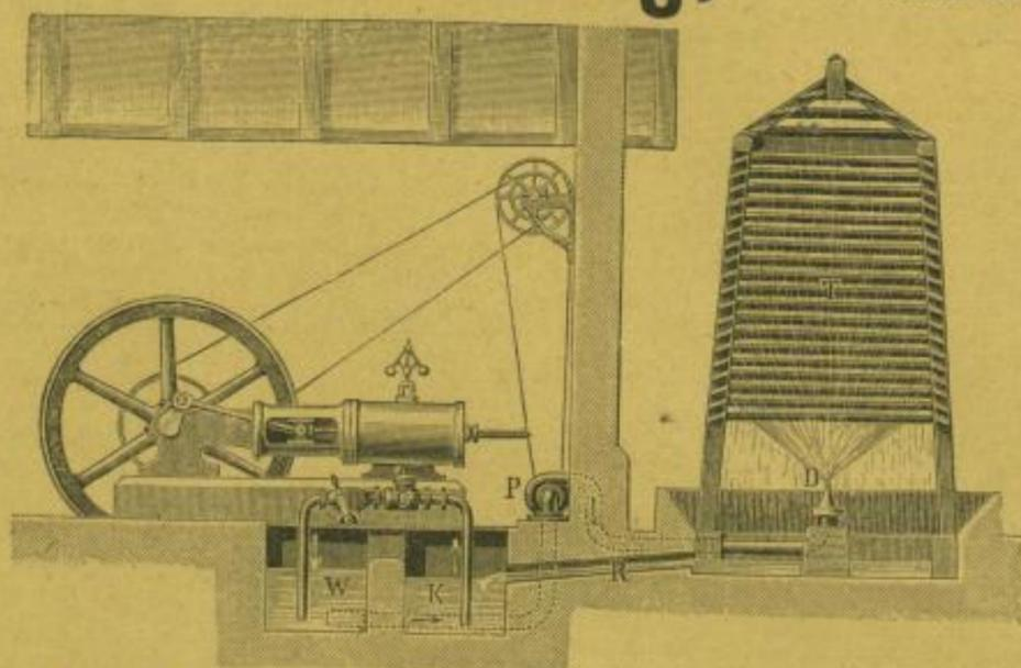
**Condensations-Anlage** mit Kühlung des gebrauchten Wassers durch
