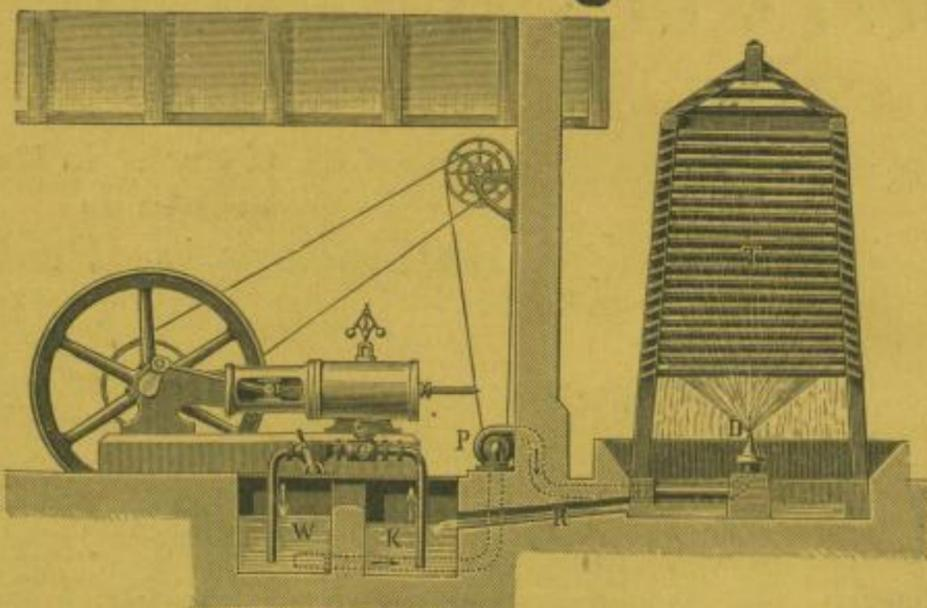
**Condensations-Anlage** mit Kühlung des gebrauchten Wassers durch
