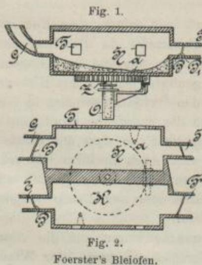
zwei durch eine Scheidewand *W* von einander getrennten Längskammern *H* und *K* und kann um einen Zapfen *Z*, der in bekannter Weise hydraulisch etwas angehoben wird, in wagerechter Ebene um  $180^\circ$  gedreht werden.
