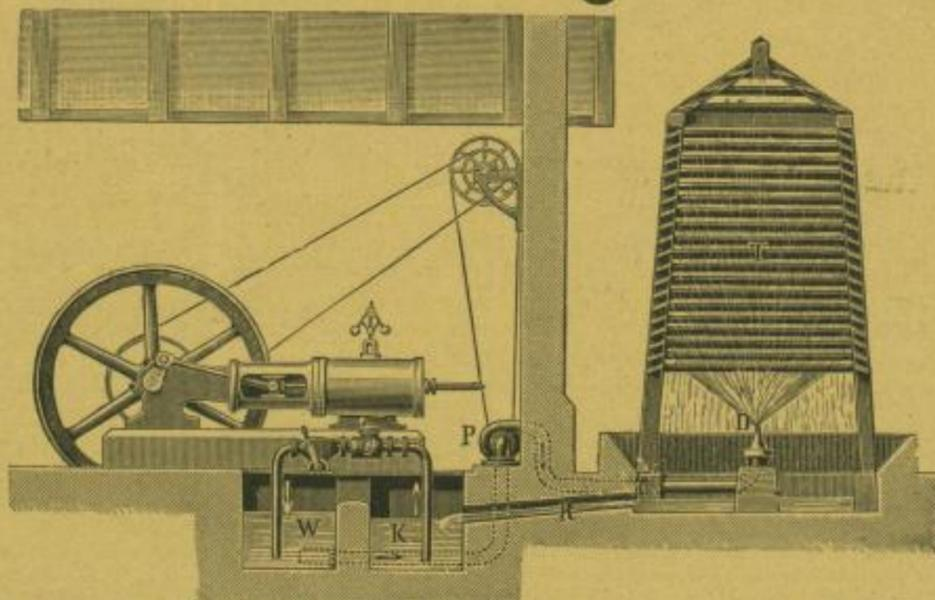
**Condensations-Anlage** mit Kühlung des gebrauchten Wassers durch
