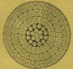
**Drahtseile Patent verschlossener Construction**
