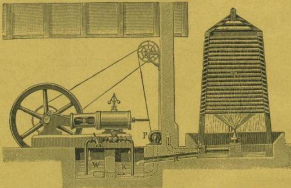
Condensations-Anlage mit Kühlung des gebrauchten Wassers durch
