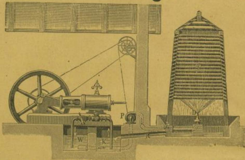
**Condensations-Anlage** mit Kühlung des gebrauchten Wassers durch
