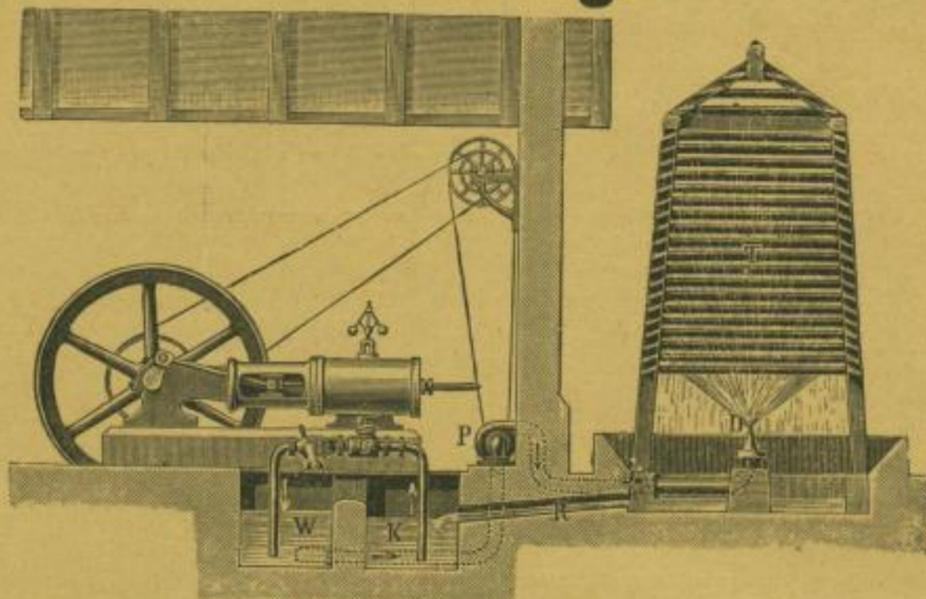
**Condensations-Anlage** mit Kühlung des gebrauchten Wassers durch
