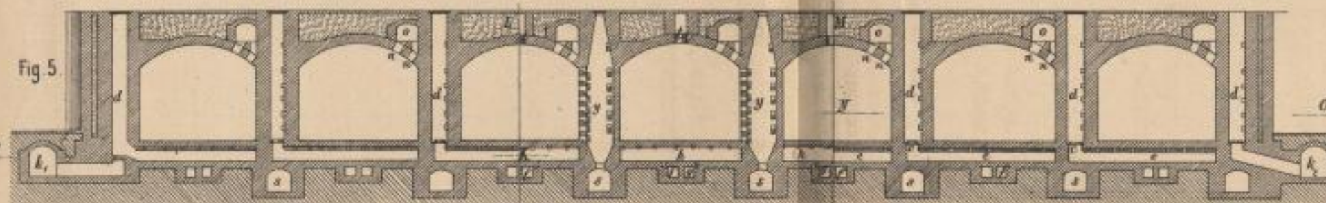
Schnitt AB. Künne's Gasfeuerung für Ringöfen (1-3) Schnitt CD.
