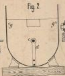
Apparate zur Trennung des Chornatriums u. Chlormagnesiums von Kaliummagnesiumsulfat. (3-7)
