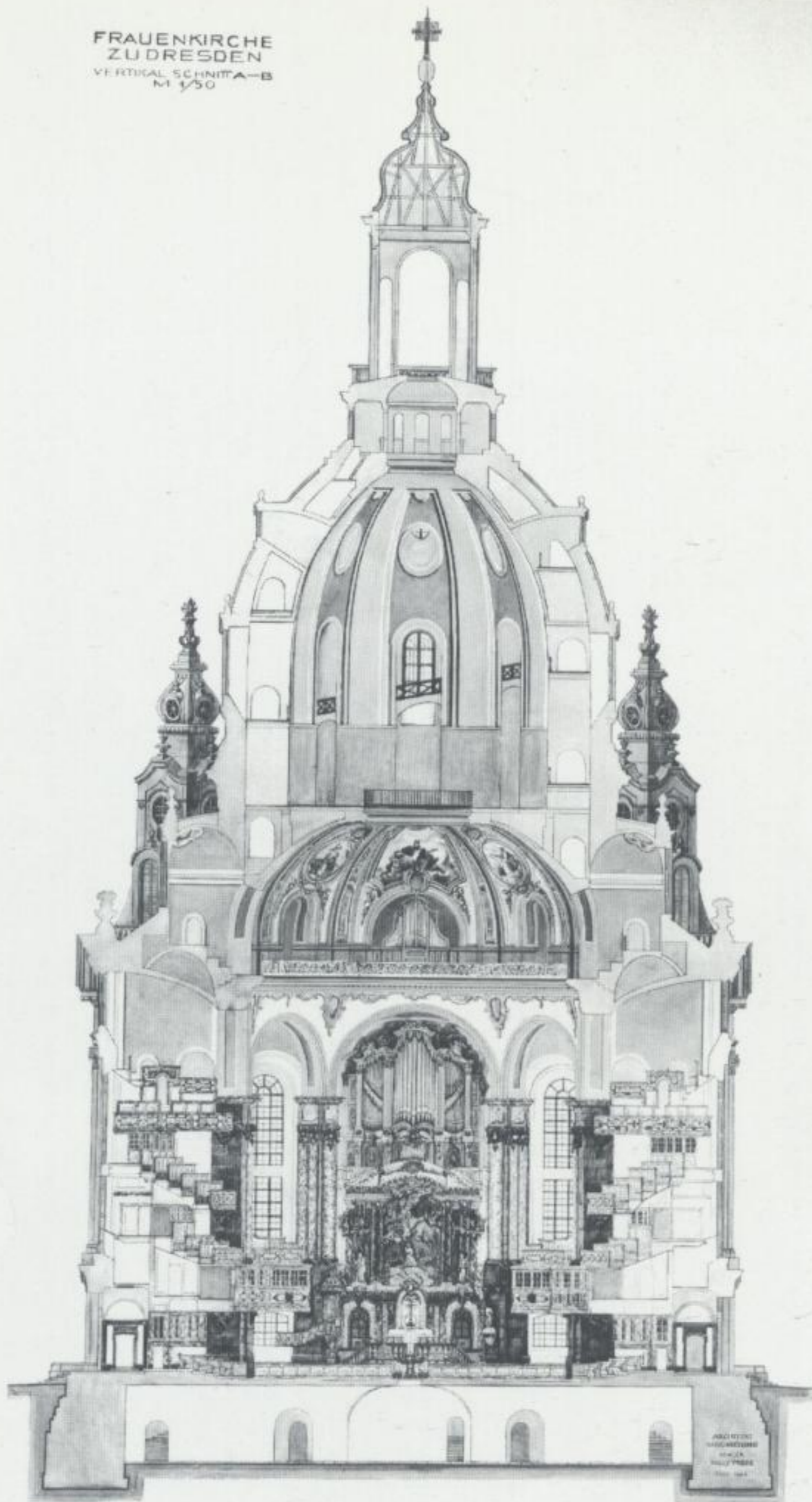
Nord-Süd-Schnitt durch die Frauenkirche Plan von Arno Kiesling und Willi Trede 1946
