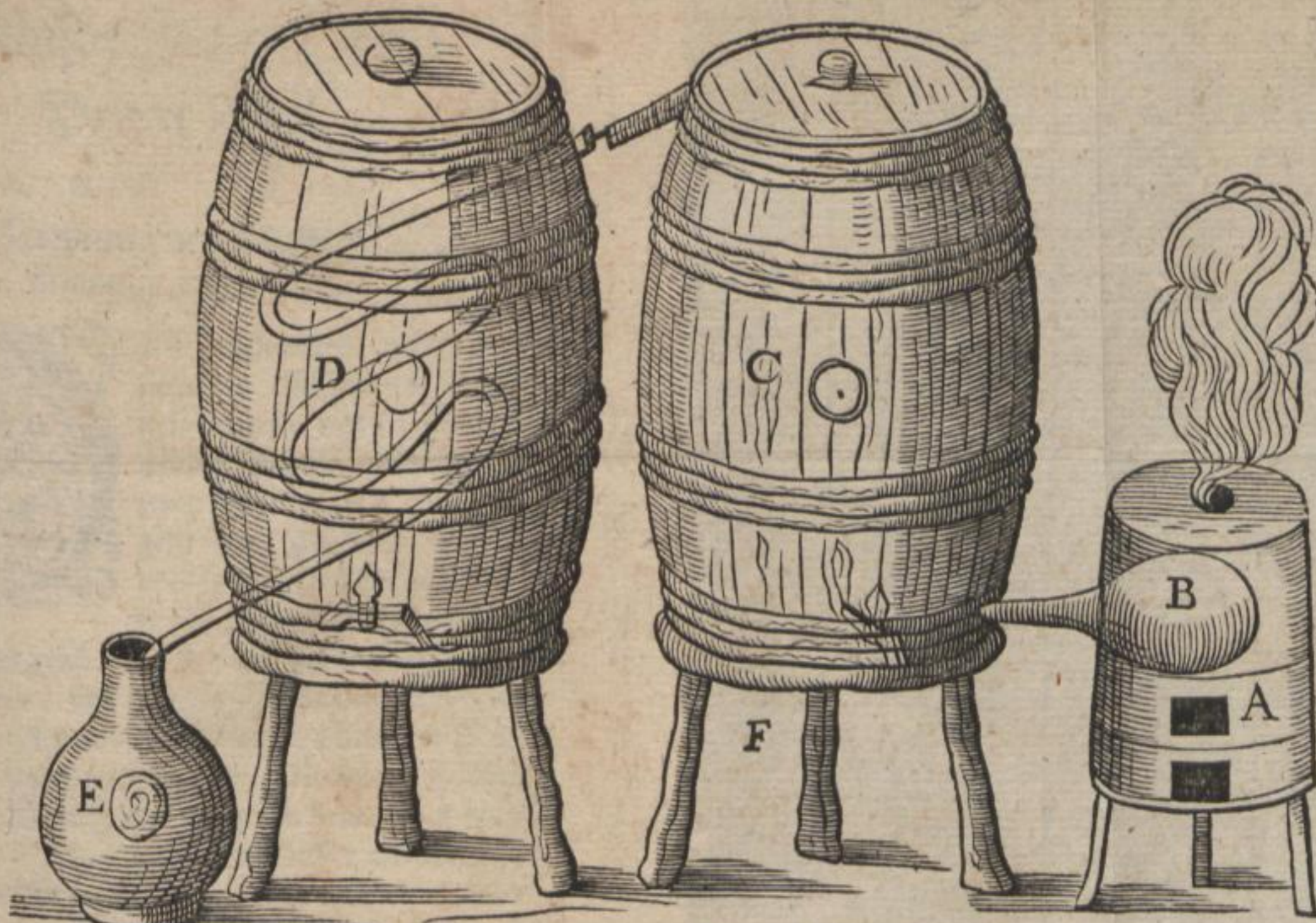
A Der Ofen darin die kupfferne Kugel ligt. B Das kupfferne Gefäß. C Das Faß darin der Zeug distilliret wird.
