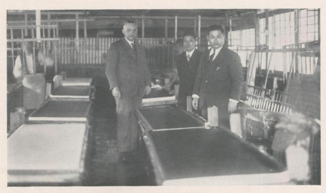
Auf der rechten Seite des Bildes ein Rechen aus Holz, mit dem der Papierbrei mit Wasser vermischt und gleichmäßig verteilt wird. Im Vordergrund Siebe, mit denen das Papier geschöpft wird. Die fertigen Bogen werden noch feucht aufseinandergelegt und kleben, trotzdem sie verhältnismäßig dünn sind, nicht zusammen
