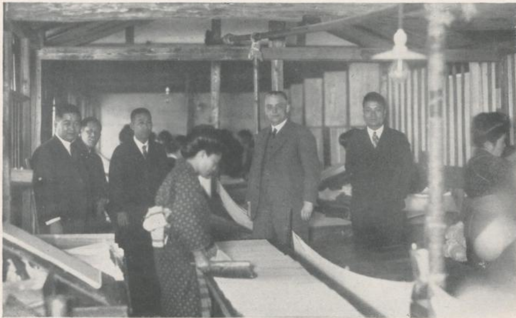
Das Papier wird mit Dampf getrocknet und mittels eines feinen Hand-Haarbesens von dem Dampfapparat genommen. Diese Arbeit versehen ausschließlich Frauen
