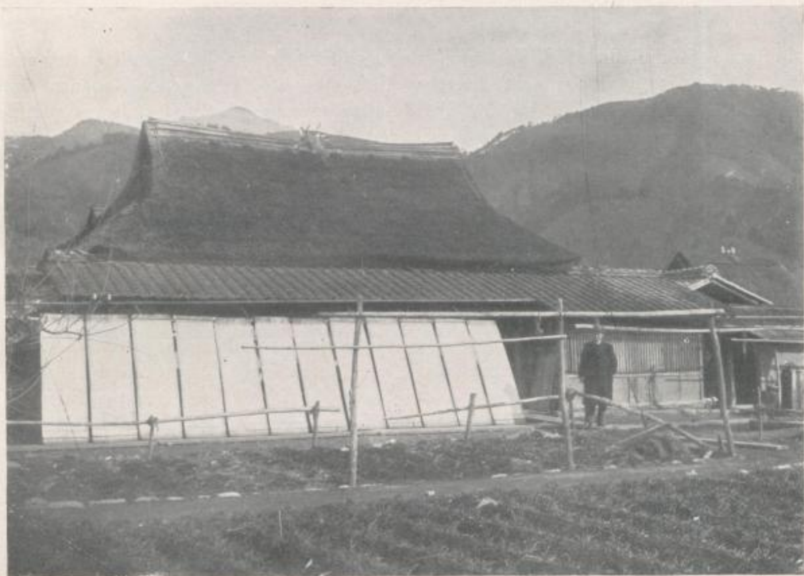
Von dem noch feuchten Papier werden etwa 7 Bogen auf ein Holzbrett gelegt und an der Luft getrocknet Das Verfahren ist zeitraubender und braucht mehr Raum wie das Trocknen mittels Dampfapparates About seven sheets of the paper, still moist, are laid on a wooden board and dried in the open air This process needs mor time and also more space than the procedure of drying by steam
