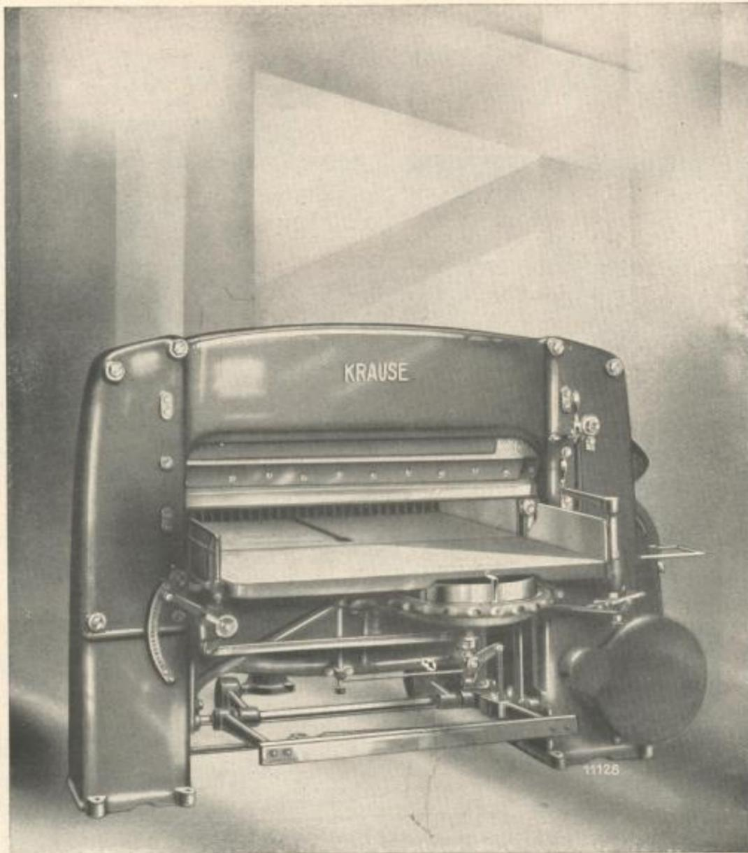
Die Schnellschneider KRAUSE werden in 76, 92, 104, 115, 130, 150, 165, 210 und 270 cm Schnittlänge in verschiedenen Ausführungen gebaut.
