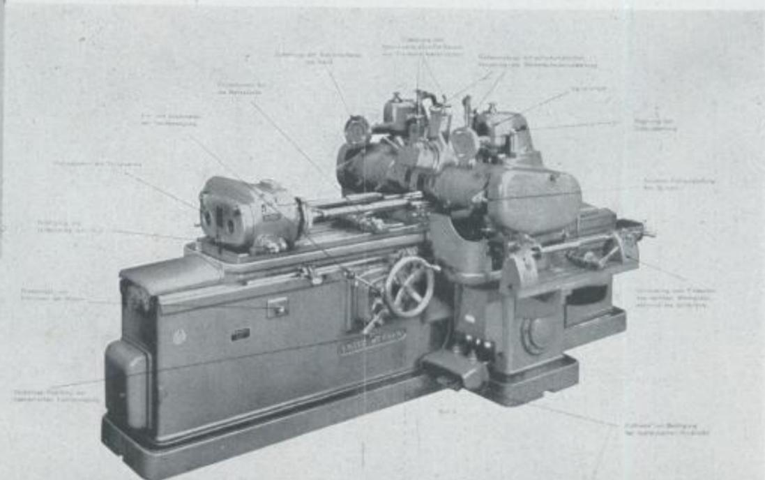
Doppelspindlige Schaltwellen-Schleifmaschine Typ 276
