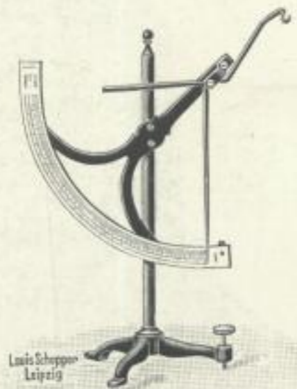
Schopper Reduktions-Papierwaage zur Bestimmung des \square Meter-Gewichts
