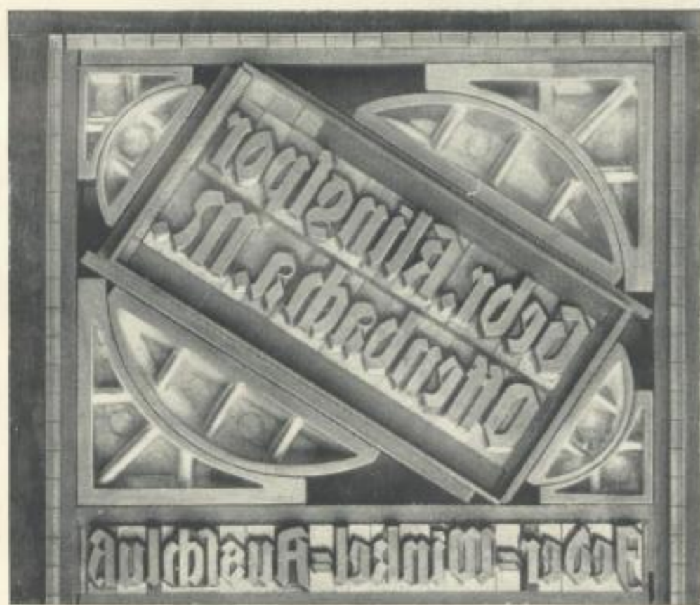
Schrägstellung des Satzes mit „Drehwinkel-Ausschluß“ Gebr. Klingspor, Offenbach a. M.
