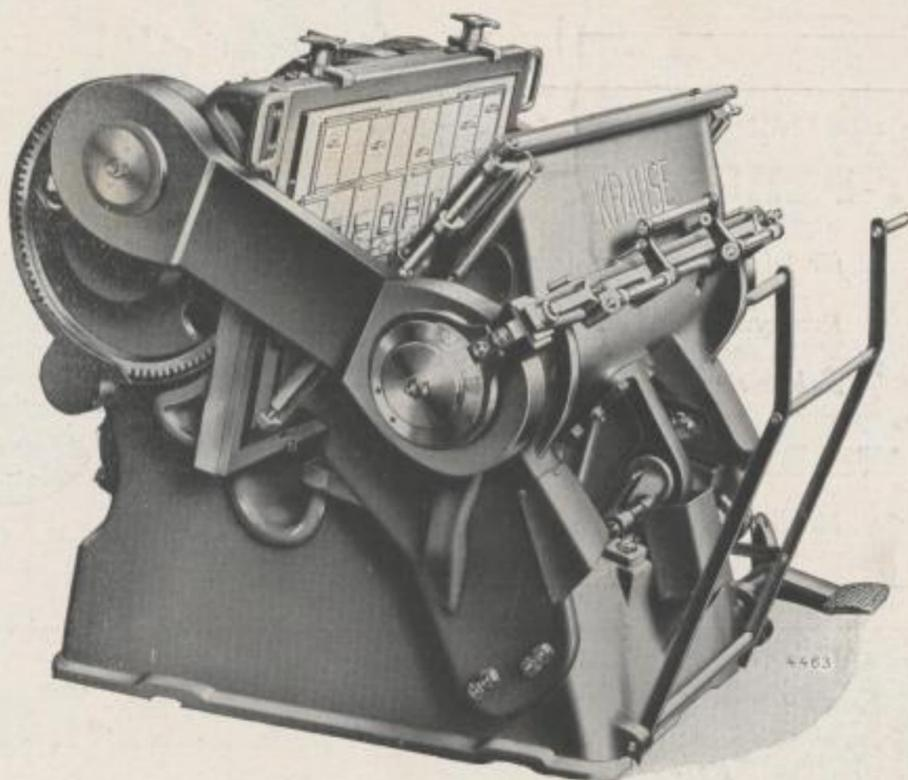
*Der Stanztiegel KRAUSE hat fein einstellbaren Druck, patentiertes Zurichteverfahren
