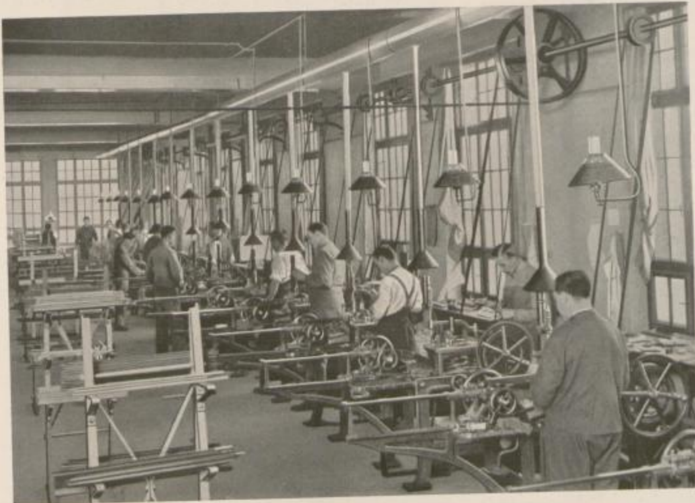
1905 Ein neuer Vießsaal mit englischen Komplettgießmaschinen
