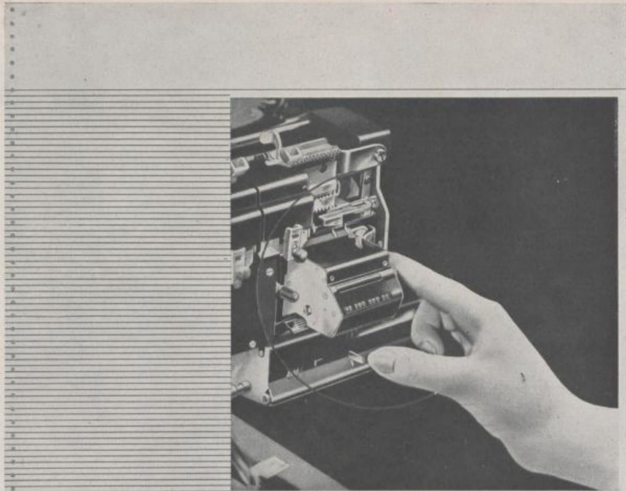
Per far funzionare soltanto il sistema verticale dei totalizzatori, si può disinnestare il cross spostandolo a sinistra e premendo una levetta. Esso resta quindi escluso dal sistema calcolante.
