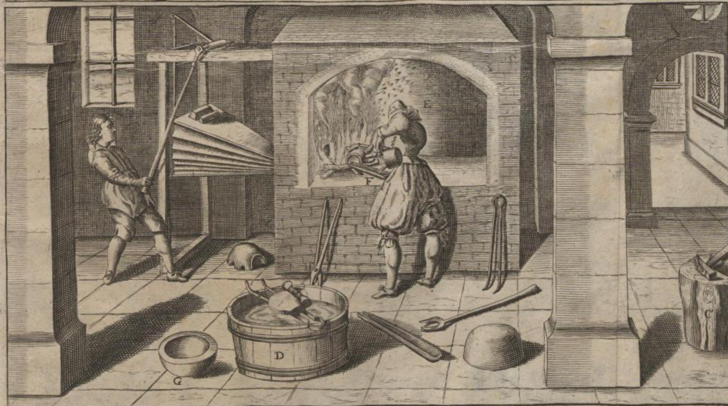
A Die Brennofen darinn man das Bleck Silber brennet. B Die Müffeln C Der Klotz darauß man die Bleck Silber entzwey ſchlag D Die Kühlfaßer darinn man die Brand Silber abkület. E Die Silber brenner. F Daß Silber brennen vorm geblaß G Die Teße H Blic Silber. I Brand Silber
