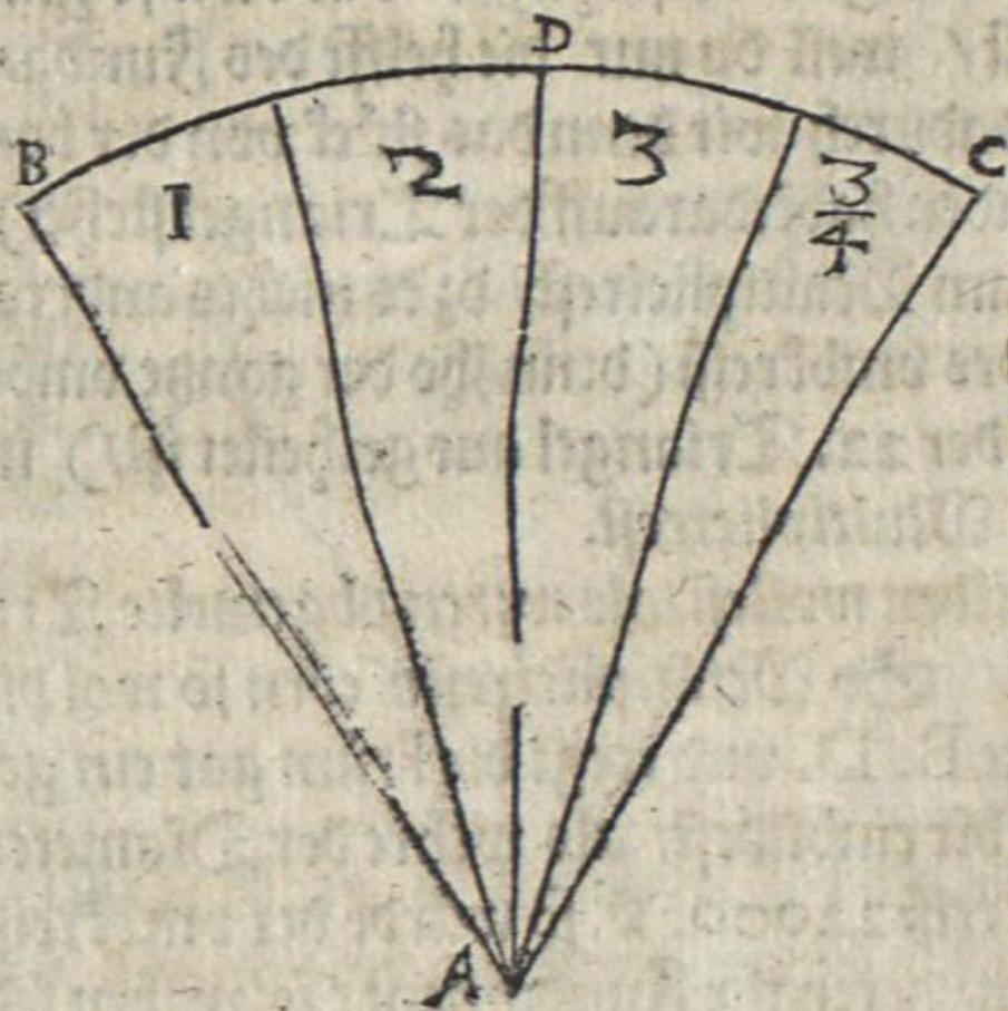
Als in der Figur A. B. C. D. so du wilst die ware groß derselben haben / handelstu wie jett gemeldet / so kömpt dir die groß der Triangel / so zwischen den zweyen halben Diametris A. B. vnd A. C. durch de bogen / B. D. C. begriffen werden / Also / so dir gegeben wird die Figur L. M. N. O. P. Do du es auff vorigen weg machest / kömpt dir
