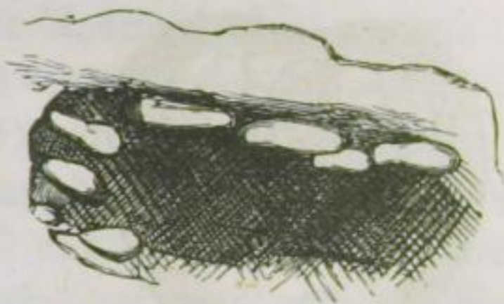
Fig. 10. Sandsteinfragment, worin eine Höhlung mit Kohlenpulver. Bohrlochausfüllungen zusammengedrückt.
