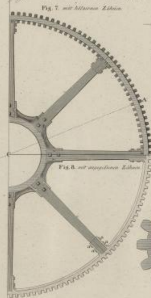
Rad mit Armen von Holz, dann gusseisernem Rad- und Well-Kranze.
