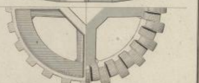
Fig. 18. Vorderansicht. Rückansicht. Fig. 19. des gusseisernen konischen Rades.
