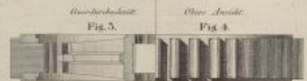
Rad mit gusseisernem, an die Arme angeschraubtem Kranze und hölzernen Zähnen.
