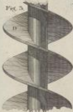
Seitenansicht der Windung einer Wasserschnecke.
