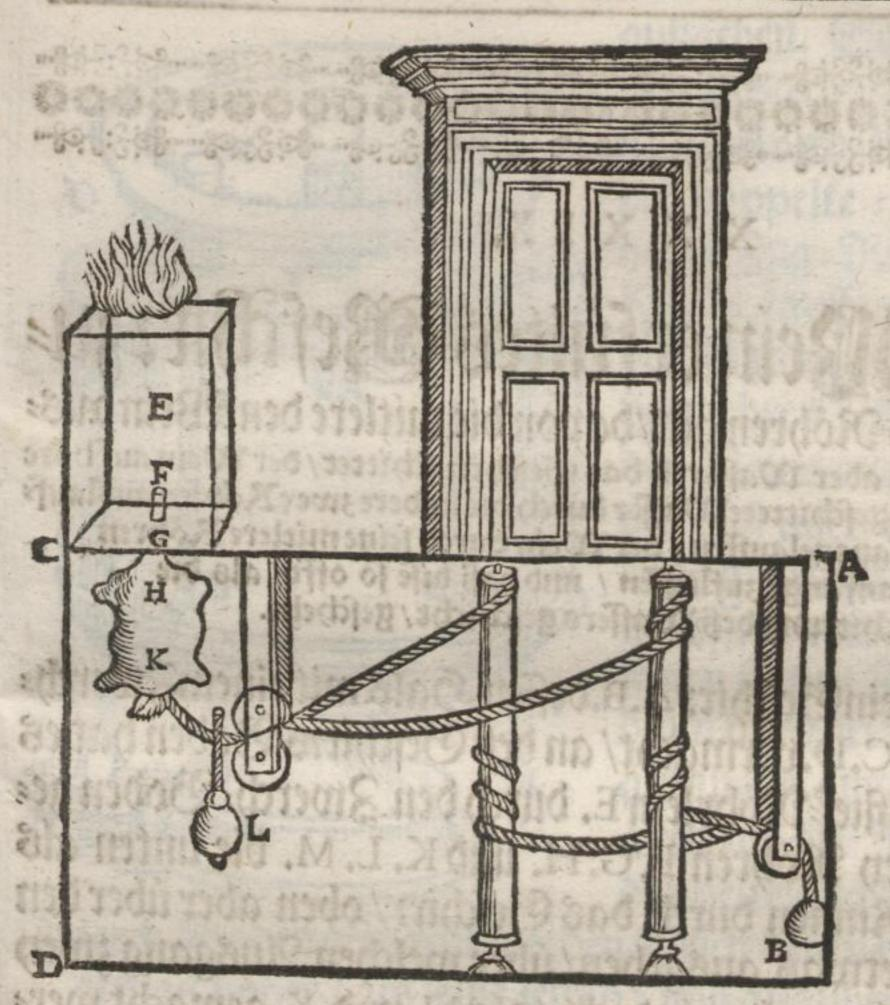
tar von der war= me ausgebreitet: wird durch die Röhren F.G.H. in den Schlauch getrieben/daßer also den schlauch und das gewicht L. ansich ziehet/ und die Thorer= öffnet werden:es werden also die Thor von sich selbsten sich erof= nen / gleich den thuren einer bad= Stuben/die sich selbsten zuschlies= sen.Oder sie wer=
