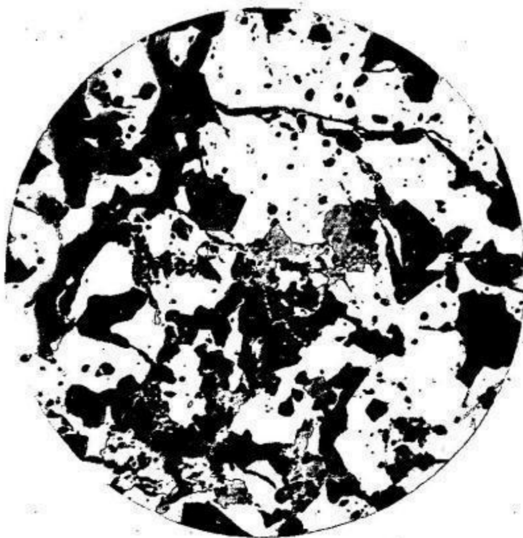
(Abb. 3.) Polierter Anschliff, ungeätzt; Vergr.: 43 × Innige Verwachsung von Mag- netit (weiß, löcherige Ober- fläche); Lagergestein Salit und Granat (hell- und dunkelgrau).
