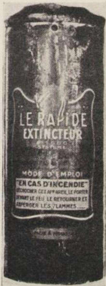
Abb. 4. Ein angeblicher Feuerlöscher, gefüllt mit einer leicht entzündbaren Lösung; hinter der oberen Öffnung ein Stopfen aus Platinschwamm.
