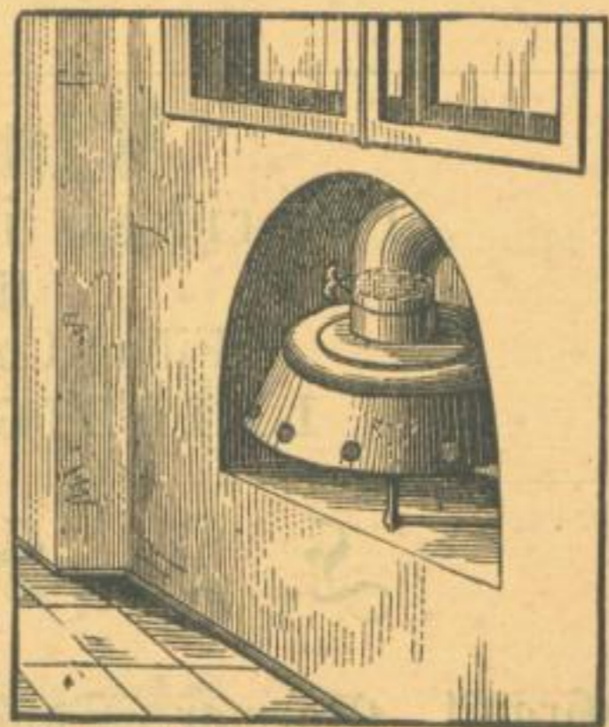
Durch die Mauer gezogener, in der Mauer hangender Apparat. Gasheizung, event. Oel- od. Petroleumheizung.
