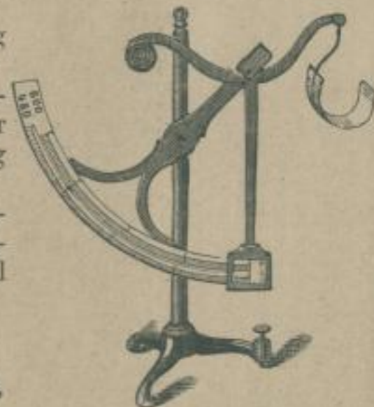
Papier-Waage zur Bestimmung der Bogenzahl.
