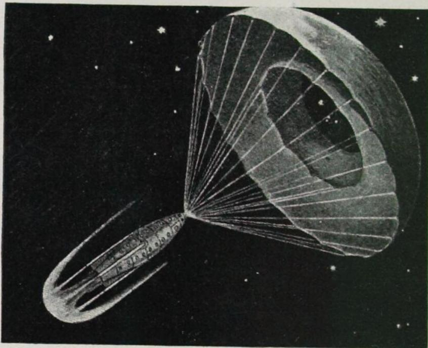
Rückkehr in den Luftkreis der Erde. Der entfaltete Fallschirm zieht die Spitze des Raumschiffs nach rückwärts, so dass die mit Vollgasarbeitenden Düsen durch den Gegenstoss der auspuffenden Gase den Fall bremsen. Der Gasstrom biegt infolge des Luftwiderstandes um und bildet eine kometenschweifartige Haube
