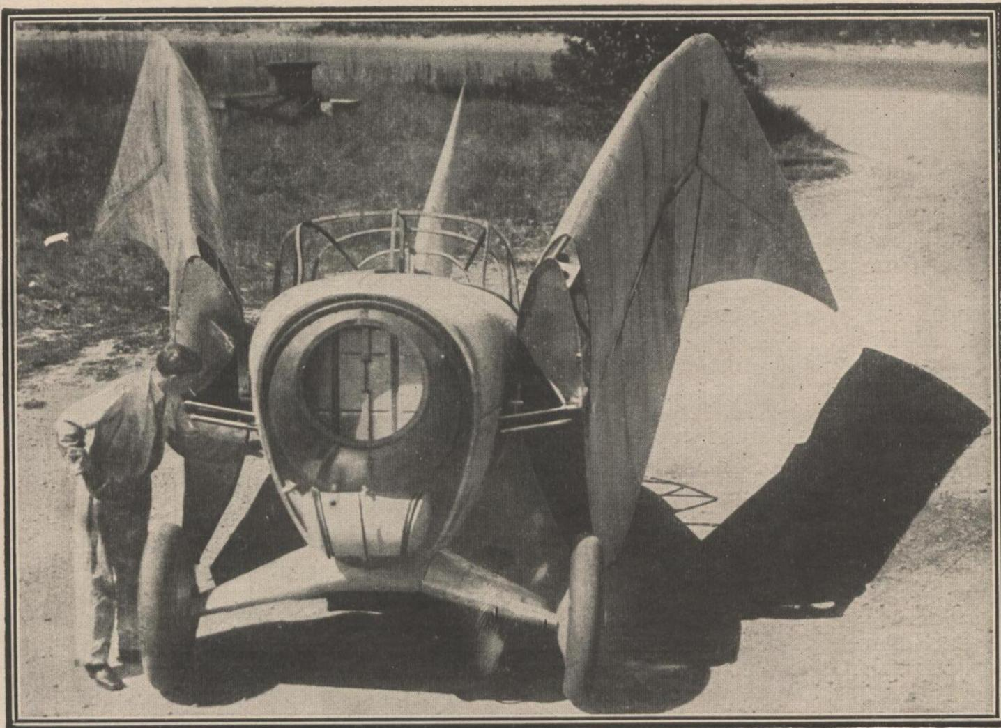
„Das Mövenflugzeug“, ein neuer Flugzeugtyp der U. S. A., eine Konstruktion von W. Bunney. Der autoähnliche Apparat beherbergt 2 Personen. Seine Flügel sind denen der Seemöve nachgebildet und werden beim Landen zurückgeworfen, was eine rasche Bremswirkung und Platzersparnis zur Folge hat.
