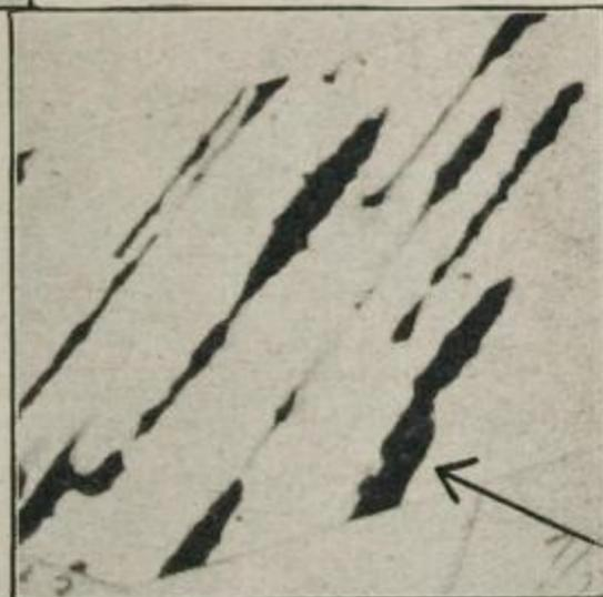
Aus größerer Entfernung unter spitzem Winkel aufgespritzte Tropfen
