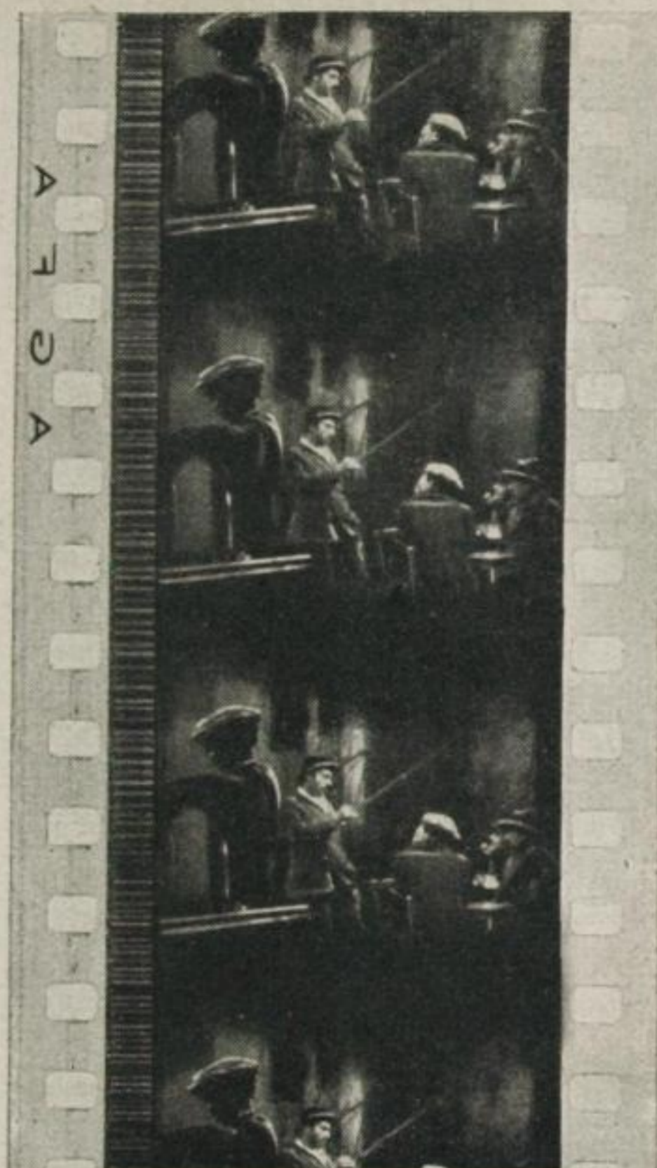
So sieht der fertige Tonfilmstreifen aus, der Bild und Ton vereinigt
