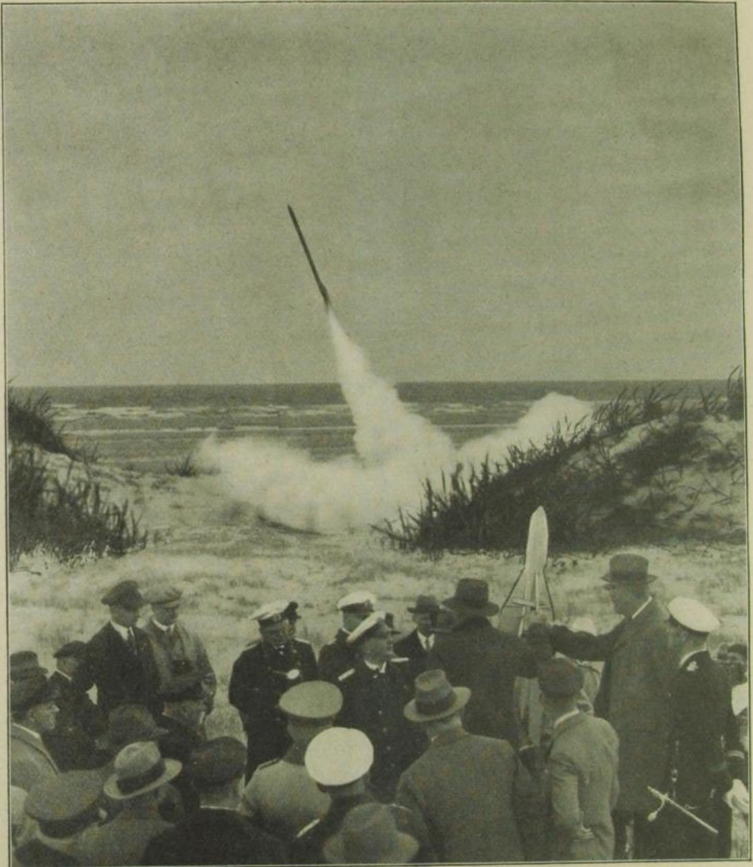
Auf der Nordseeinsel Wangeroog demonstrierte der deutsche Ingenieur Tiling mit seiner 2 m langen Versuchsrakete die ersten Probeflüge
